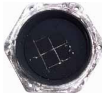
●灰が堆積して破損したDPF
