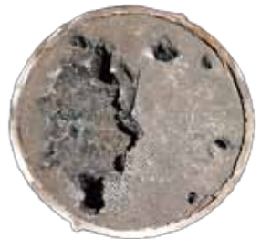
●灰が堆積して破損したDPF
